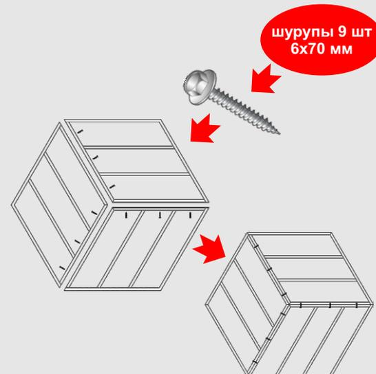
Собираем три секции пола беседки скрепляя между собой шурупами 6x70 мм в количестве 3 шт. на стык (9 шт). Переворачиваем пол лицевой частью вверх
